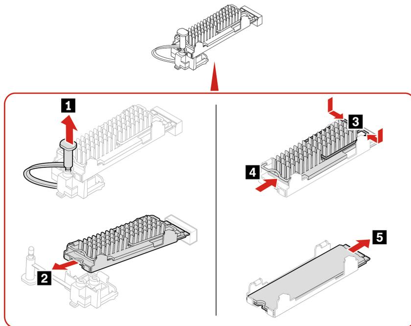
**Nota:** Quando si installa l'unità SSD M.2 e il dissipatore di calore, rimuovere la pellicola (se presente) che copre il pad termico.
