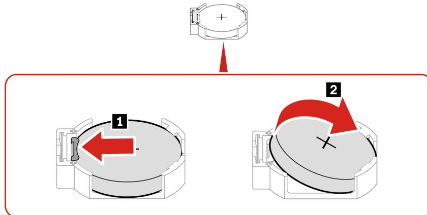
**Nota:** Dopo l'installazione di una nuova batteria in formato moneta, reimpostare la data e l'ora del sistema nel menu UEFI BIOS.
