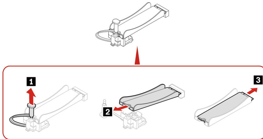
**Nota:** Quando si installa l'unità SSD M.2 e il dissipatore di calore, rimuovere la pellicola (se presente) che copre il pad termico.
