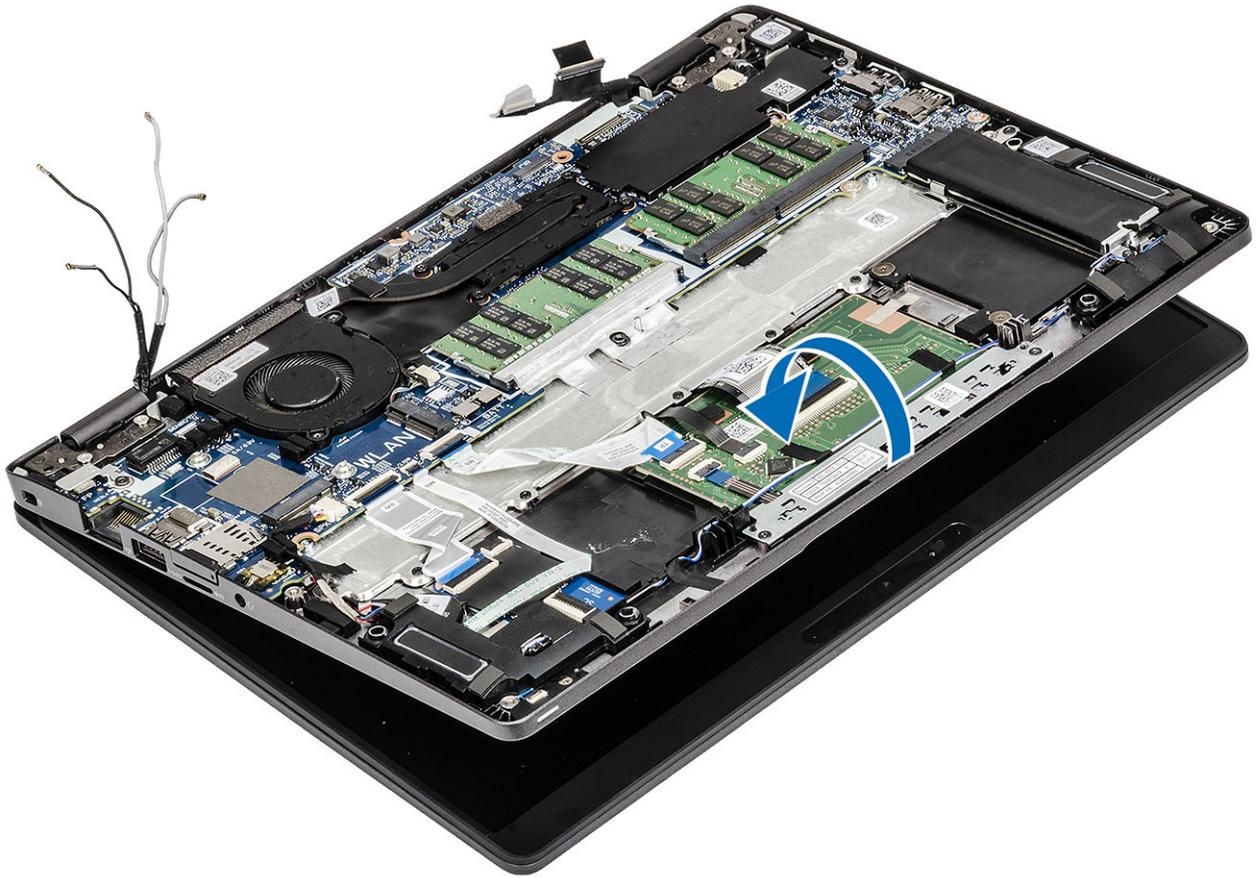
6. Rimuovere le 4 viti (M2.5x3) che fissano il gruppo del display allo chassis del sistema [1].
