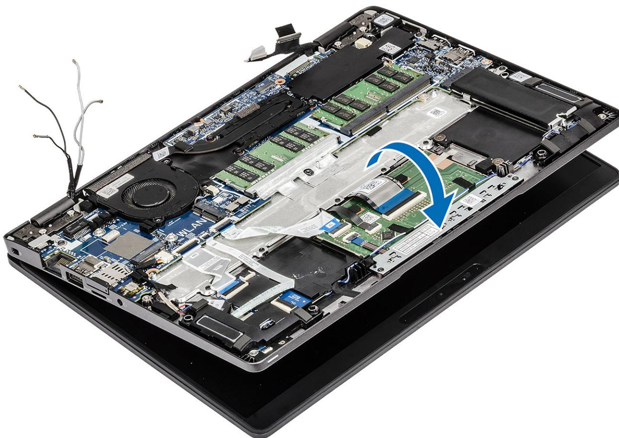
4. Collegare il cavo al connettore sulla scheda di sistema e far aderire il nastro adesivo [1].
